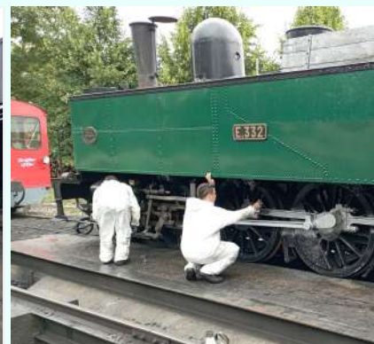
Une sympathique équipe s'est constituée cet été pour préserver et redonner un bel aspect à cette superbe machine. Ici peinture des roues et traitement de protection des bielles.
