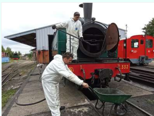
Nettoyage de la boîte à fumée et de la colonne d'échappement de la 230 E 332 « Bretonne ». Il était temps !
