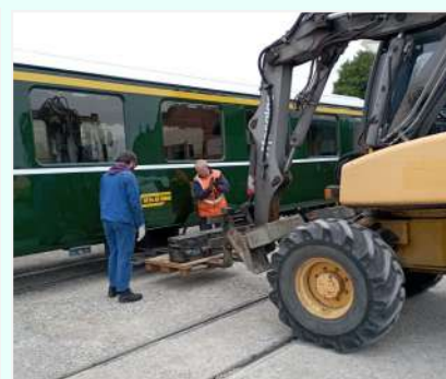
On installe la batterie sur une voiture RHB en vue de sa mise en service.
