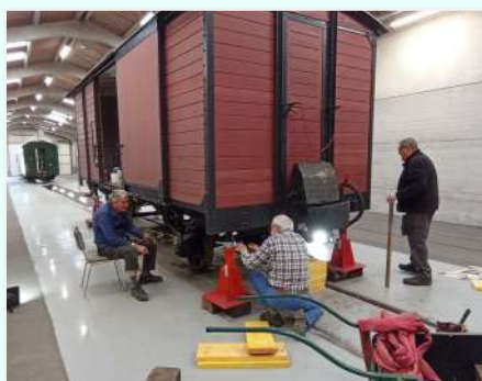
11/2025 : on redescend doucement le fourgon D 422 sur ses essieux.
